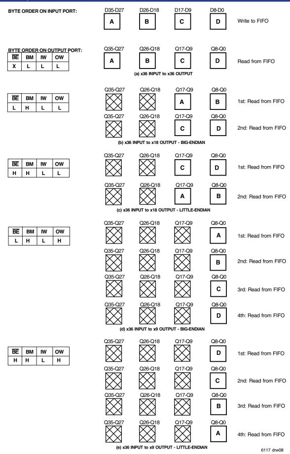
Figure 4. Bus-Matching Byte Arrangement
