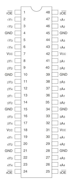
SSOP/ TSSOP/ CERPACK TOP VIEW
