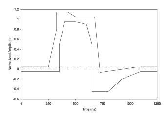
Figure-5 DSX-1 Waveform Template
