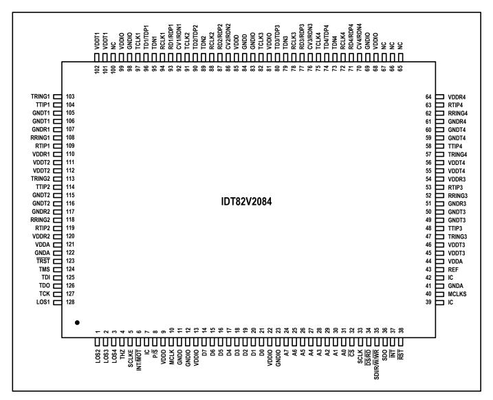
Figure-2 IDT82V2084 TQFP128 Package Pin Assignment
