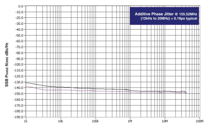
OFFSET FROM CARRIER FREQUENCY (Hz)
