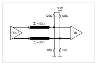
FIGURE 3B. LVPECL OUTPUT TERMINATION
