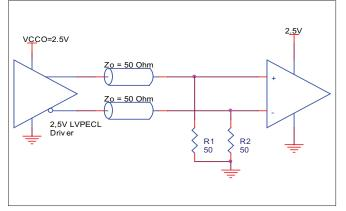
FIGURE 4C. 2.5V LVPECL TERMINATION EXAMPLE
