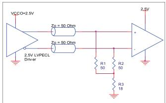
FIGURE 4B. 2.5V LVPECL DRIVER TERMINATION EXAMPLE
