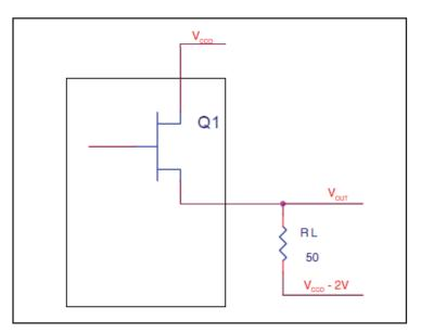
FIGURE 6. LVPECL DRIVER CIRCUIT AND TERMINATION
