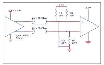
FIGURE 4A. 2.5V LVPECL DRIVER TERMINATION EXAMPLE
