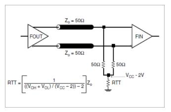
FIGURE 3A. LVPECL OUTPUT TERMINATION
