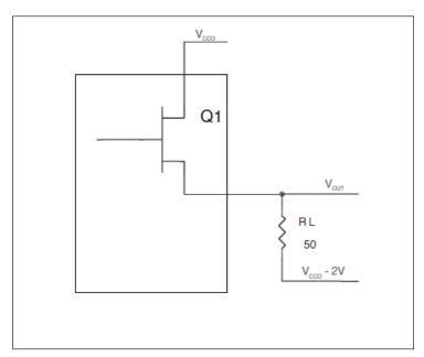
FIGURE 5. LVPECL DRIVER CIRCUIT AND TERMINATION
