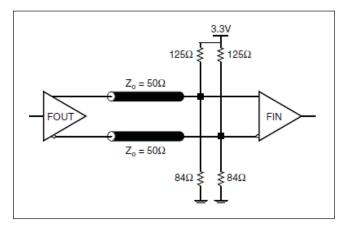
FIGURE 4B. LVPECL OUTPUT TERMINATION
