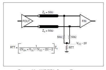
FIGURE 4A. LVPECL OUTPUT TERMINATION
