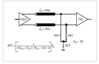
FIGURE 4A. LVPECL OUTPUT TERMINATION
