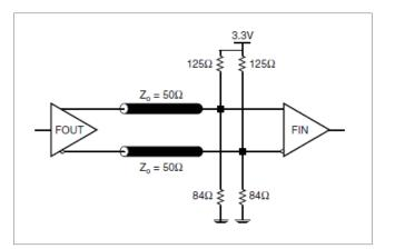
FIGURE 4B. LVPECL OUTPUT TERMINATION
