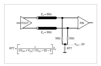
FIGURE 2A. LVPECL OUTPUT TERMINATION
