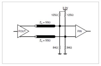
FIGURE 2B. LVPECL OUTPUT TERMINATION
