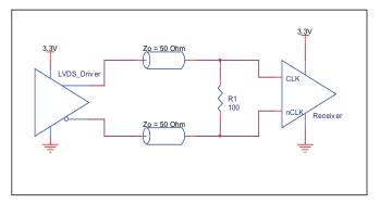
FIGURE 2D. HSTL\_CLK/nHSTL\_CLK INPUT DRIVEN BY 3.3V LVDS DRIVER
