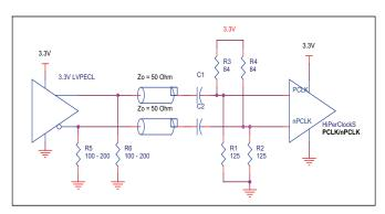
FIGURE 3E. PECL\_CLK/nPECL\_CLK INPUT DRIVEN BY A 3.3V LVPECL DRIVER WITH AC COUPLE
