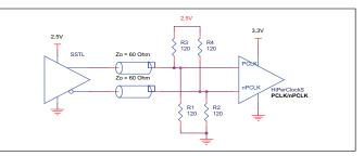
FIGURE 3B. PECL\_CLK/nPECL\_CLK INPUT DRIVEN BY AN SSTL DRIVER
