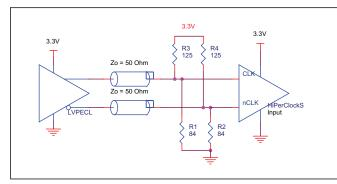
FIGURE 2C. HSTL\_CLK/nHSTL\_CLK INPUT DRIVEN BY 3.3V LVPECL DRIVER
