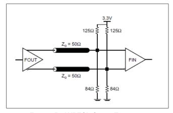
FIGURE 5B. LVPECL OUTPUT TERMINATION
