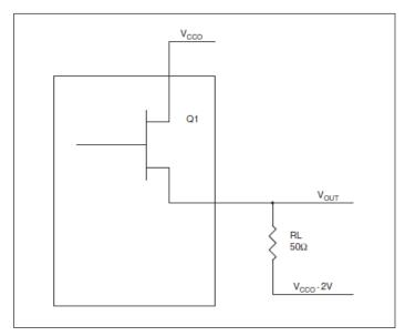
FIGURE 6. LVPECL DRIVER CIRCUIT AND TERMINATION
