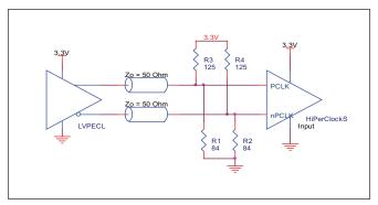
FIGURE 4C. HIPERCLOCKS PCLK/nPCLK INPUT DRIVEN BY A 3.3V LVPECL DRIVER
