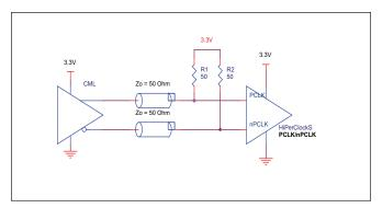
FIGURE 4A. HIPERCLOCKS PCLK/nPCLK INPUT DRIVEN
