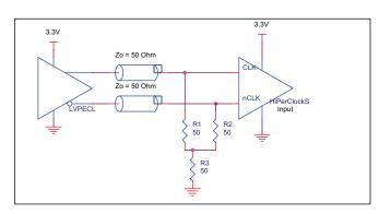
FIGURE 3B. HIPERCLOCKS CLK/nCLK INPUT DRIVEN BY 3.3V LVPECL DRIVER
