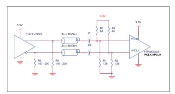
FIGURE 4E. HIPERCLOCKS PCLK/nPCLK INPUT DRIVEN
