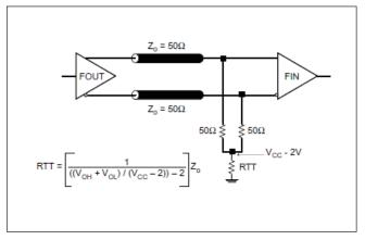
FIGURE 5A. LVPECL OUTPUT TERMINATION
