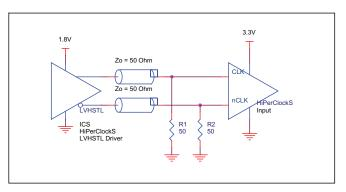
FIGURE 3A. HIPERCLOCKS CLK/nCLK INPUT DRIVEN BY IDT HIPERCLOCKS LVHSTL DRIVER
