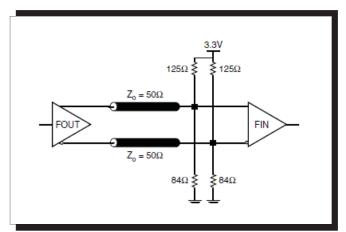
FIGURE 4B. LVPECL OUTPUT TERMINATION
