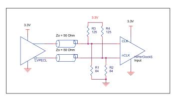
FIGURE 3C. CLK/NCLK INPUT DRIVEN BY 3.3V LVPECL DRIVER
