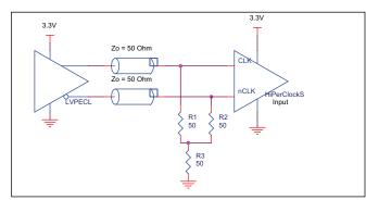
FIGURE 3B. CLK/NCLK INPUT DRIVEN BY 3.3V LVPECL DRIVER
