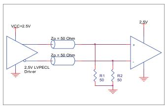
FIGURE 5C. 2.5V LVPECL TERMINATION EXAMPLE
