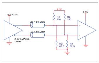
FIGURE 5A. 2.5V LVPECL DRIVER TERMINATION EXAMPLE
