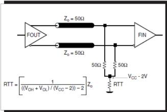
FIGURE 4A. LVPECL OUTPUT TERMINATION
