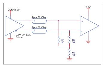
FIGURE 5B. 2.5V LVPECL DRIVER TERMINATION EXAMPLE
