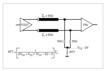
FIGURE 3A. LVPECL OUTPUT TERMINATION
