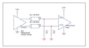
FIGURE 2A. HIPERCLOCKS CLK/nCLK INPUT DRIVEN BY IDT HIPERCLOCKS LVHSTL DRIVER
