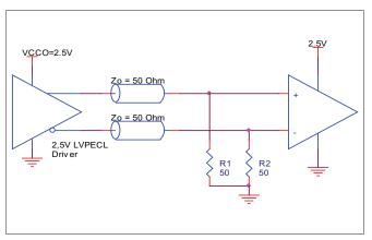
FIGURE 4C. 2.5V LVPECL TERMINATION EXAMPLE
