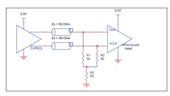
FIGURE 2B. HIPERCLOCKS CLK/nCLK INPUT DRIVEN BY 3.3V LVPECL DRIVER
