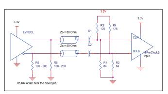
FIGURE 2E. HIPERCLOCKS CLK/nCLK INPUT DRIVEN BY 3.3V LVPECL DRIVER WITH AC COUPLE
