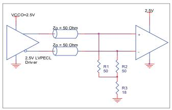
FIGURE 4B. 2.5V LVPECL DRIVER TERMINATION EXAMPLE
