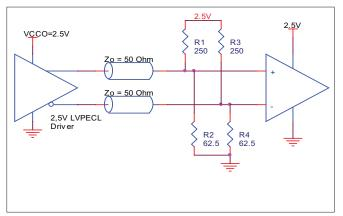
FIGURE 4A. 2.5V LVPECL DRIVER TERMINATION EXAMPLE
