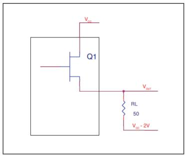
FIGURE 5. LVPECL DRIVER CIRCUIT AND TERMINATION
