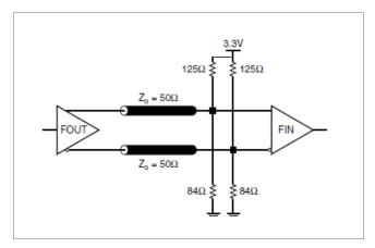
FIGURE 3B. LVPECL OUTPUT TERMINATION
