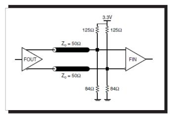
FIGURE 3B. LVPECL OUTPUT TERMINATION
