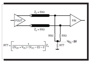
FIGURE 3A. LVPECL OUTPUT TERMINATION
