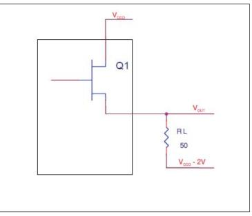
FIGURE 7. LVPECL DRIVER CIRCUIT AND TERMINATION
