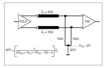
FIGURE 5A. LVPECL OUTPUT TERMINATION
