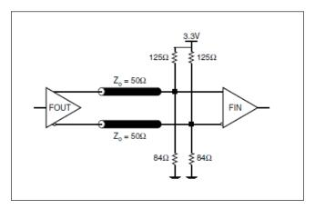
FIGURE 5B. LVPECL OUTPUT TERMINATION
