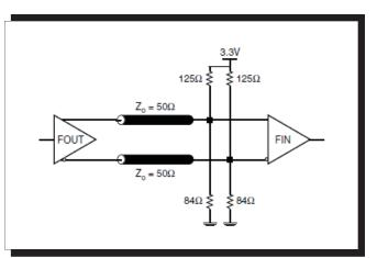
FIGURE 4B. LVPECL OUTPUT TERMINATION
