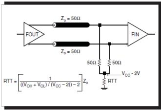
FIGURE 4A. LVPECL OUTPUT TERMINATION
