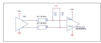
FIGURE 5A. PCLK/nPCLK INPUT DRIVEN BY A CML DRIVER
