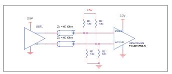
FIGURE 5B. PCLK/nPCLK INPUT DRIVEN BY AN SSTL DRIVER
