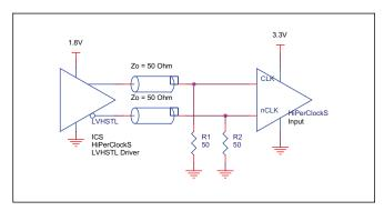
FIGURE 4A. CLK/nCLK INPUT DRIVEN BY IDT'S LVHSTL DRIVER
