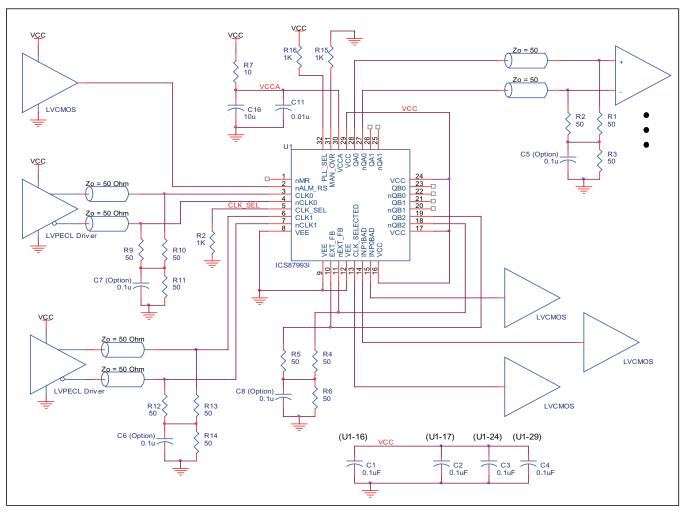
FIGURE 5A. 87993I LVPECL SCHEMATIC EXAMPLE
