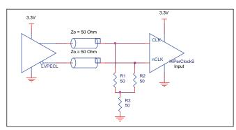
FIGURE 4B. CLK/nCLK INPUT DRIVEN BY 3.3V LVPECL DRIVER
