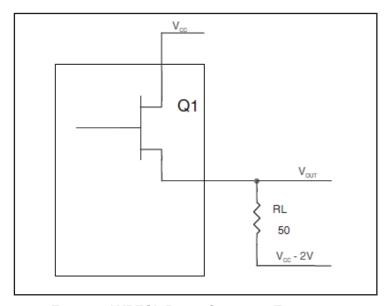
FIGURE 6. LVPECL DRIVER CIRCUIT AND TERMINATION
