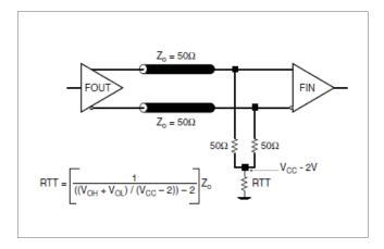
FIGURE 2A. LVPECL OUTPUT TERMINATION
