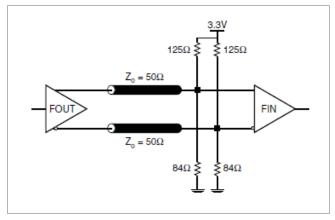
FIGURE 2B. LVPECL OUTPUT TERMINATION
