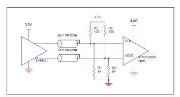
FIGURE 4C. CLK/nCLK INPUT DRIVEN BY 3.3V LVPECL DRIVER
