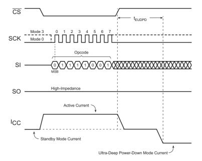
Figure 28. Entering Ultra-Deep Power-Down State
