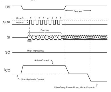
Figure 28. Entering Ultra-Deep Power-Down State
