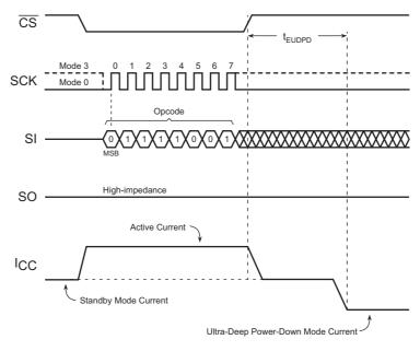
Figure 29. Entering Ultra-Deep Power-Down State
