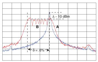
FIGURE 4B. 200MHz CLOCK OUTPUT IN FREQUENCY DOMAIN
