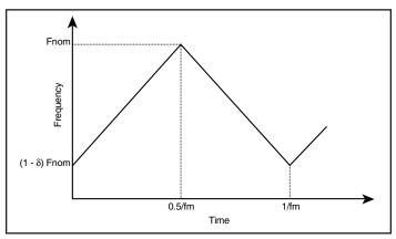
FIGURE 4A. TRIANGLE FREQUENCY MODULATION
