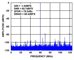
FIGURE 19. SINGLE-TONE SPECTRUM AT 190MHz
