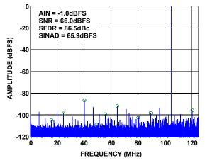
FIGURE 18. SINGLE-TONE SPECTRUM AT 105MHz
