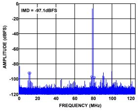
FIGURE 23. TWO-TONE SPECTRUM AT 170MHz
