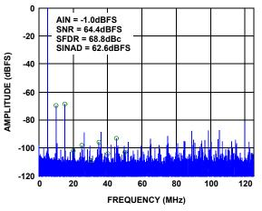
FIGURE 20. SINGLE-TONE SPECTRUM AT 495MHz
