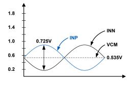
FIGURE 28. ANALOG INPUT RANGE
