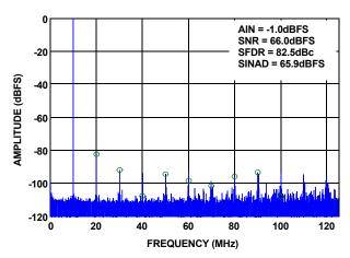
FIGURE 17. SINGLE-TONE SPECTRUM AT 10MHz
