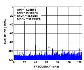
FIGURE 2. SINGLE-TONE SPECTRUM AT 105MHz (250MSPS)
