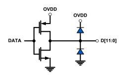
FIGURE 49. CMOS OUTPUTS
