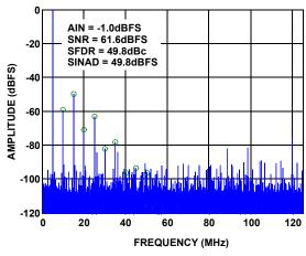
FIGURE 21. SINGLE-TONE SPECTRUM AT 995MHz
