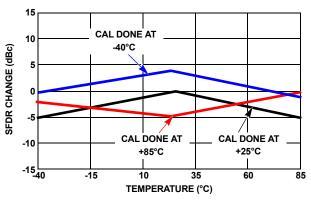
FIGURE 27. SFDR PERFORMANCE vs TEMPERATURE
