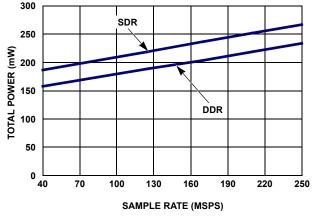
FIGURE 12. POWER vs f<sub>SAMPLE</sub> IN 3mA LVDS MODE
