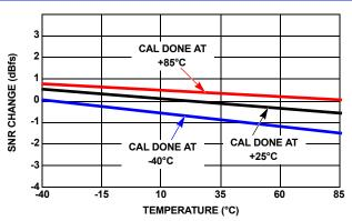
FIGURE 26. SNR PERFORMANCE vs TEMPERATURE
