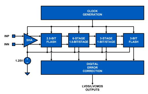
FIGURE 24. ADC CORE BLOCK DIAGRAM
