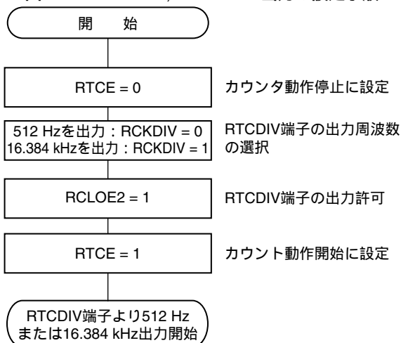
図10 - 26 512 Hz, 16.384 kHz出力の設定手順
