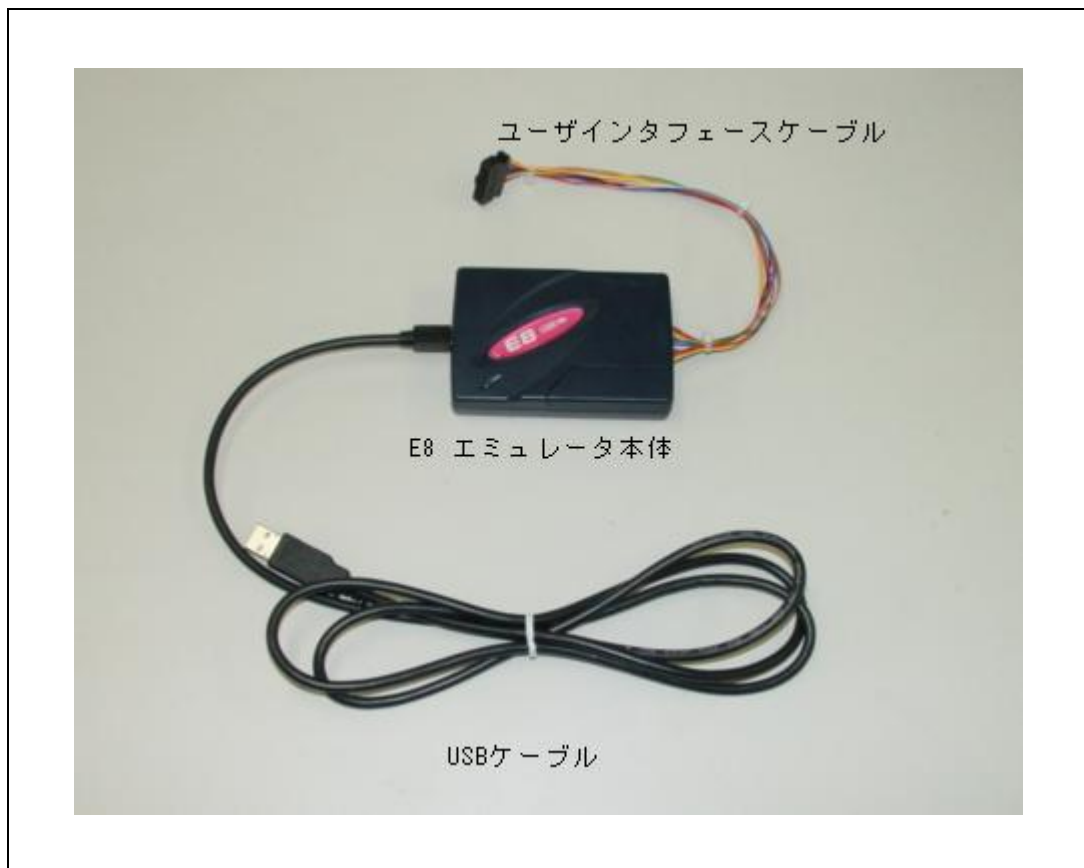
図 3.2 E8 エミュレータのハードウェア構成
