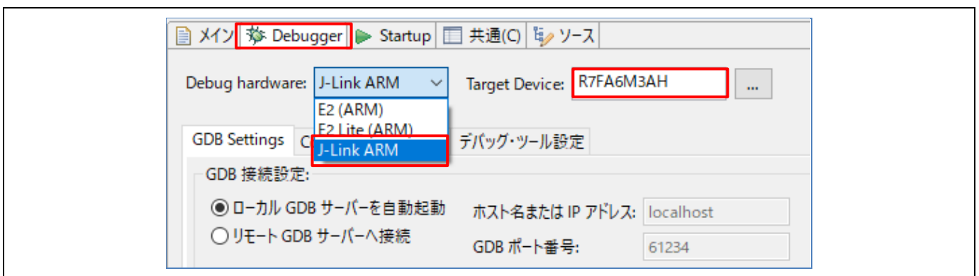
図 5-4 デバグー接続設定の変更
