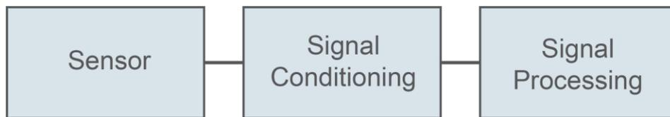
**圖 1：**基本量測系統
