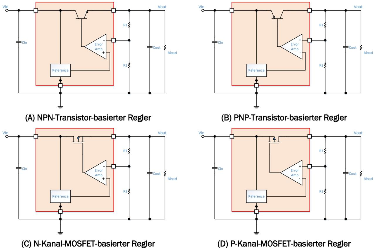
Abbildung 2. Vier verschiedene, in LDO-Reglern verwendete Transistoren
