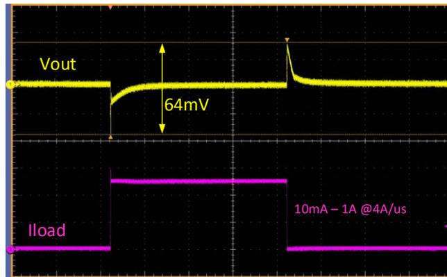
Abbildung 5. Einschwingverhalten des ISL80510 (2,2 Vin, 1,8 Vout)
