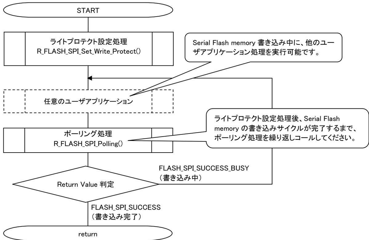
図 3.1 R\_FLASH\_SPI\_Set\_Write\_Protect()の処理例
