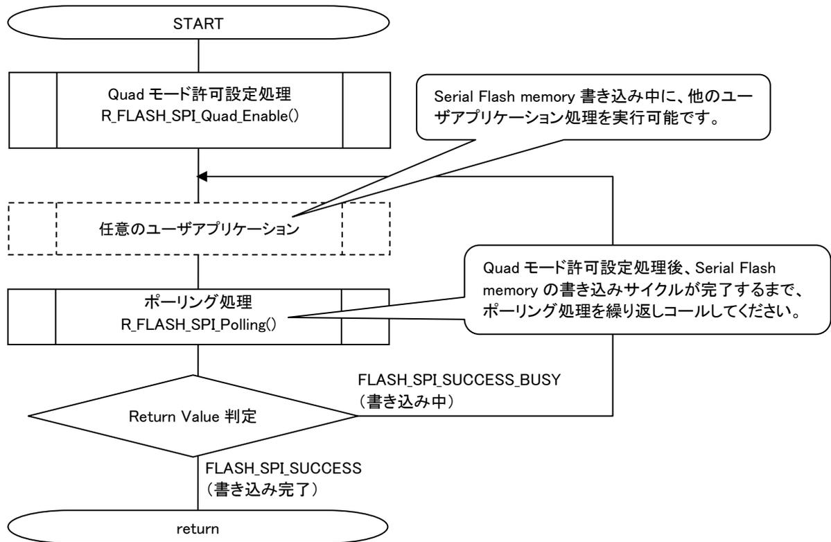
図 3.5 R\_FLASH\_SPI\_Quad\_Enable()の処理例
