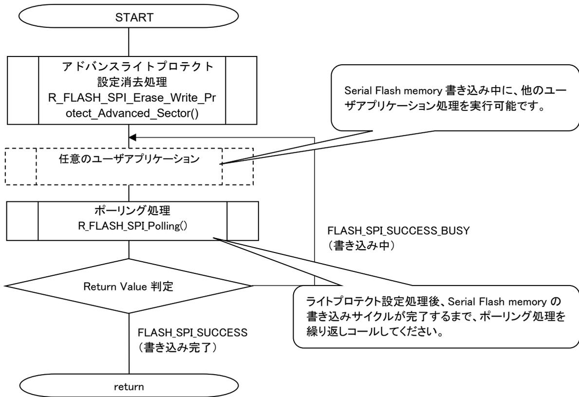
図 3.8 R\_FLASH\_SPI\_Erase\_Write\_Protect\_Advanced\_Sector()の処理例
