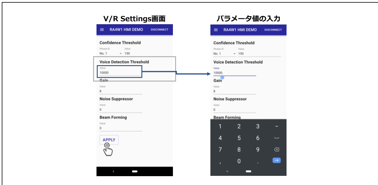
図 4.3 Voice Detection Threshold の設定
