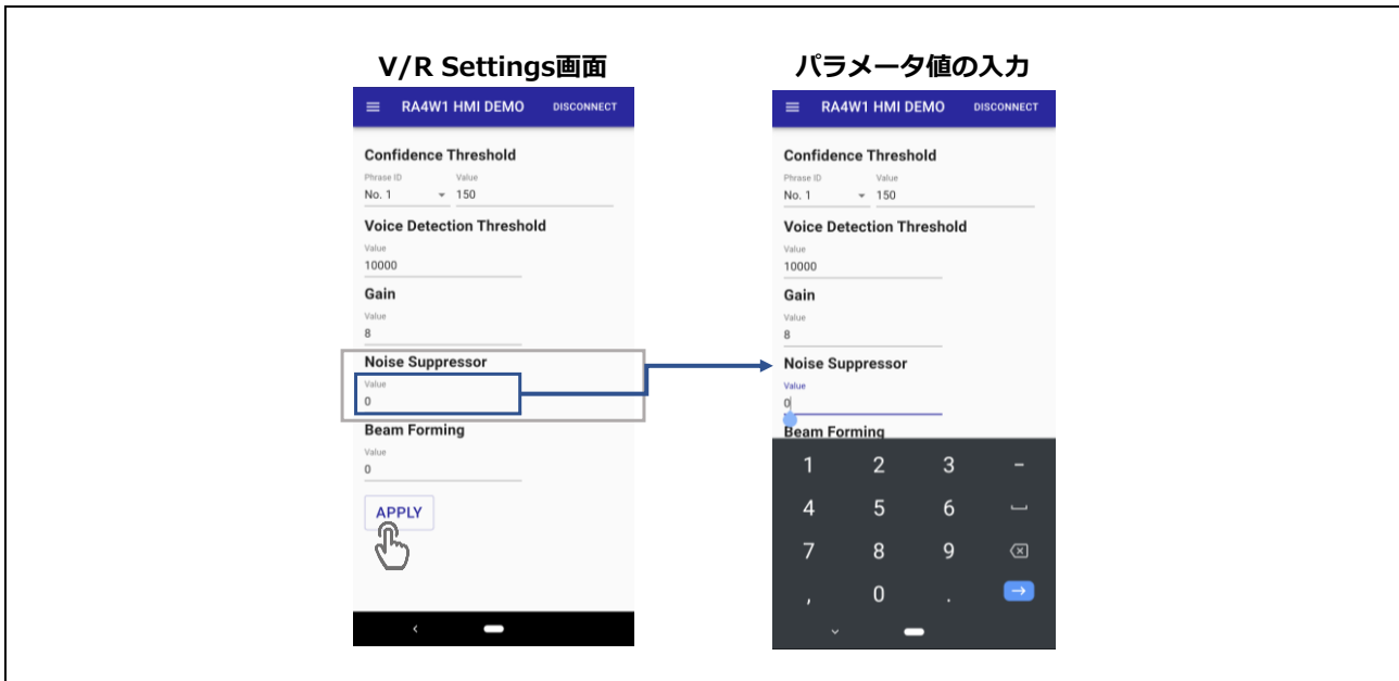
図 4.5 Noise Suppressor の設定
